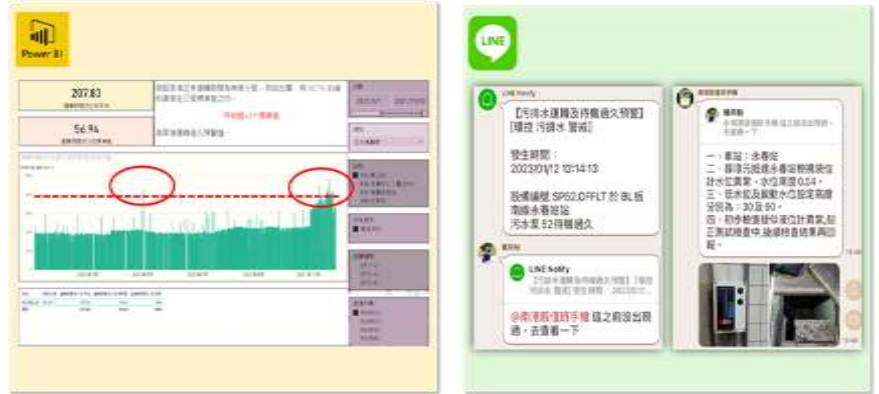
污排水系統增設Line 即時發報預警
