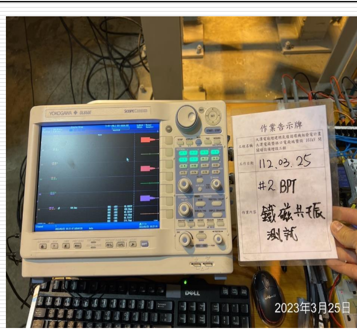
161kV GIS設備鐵磁共振測試驗證
