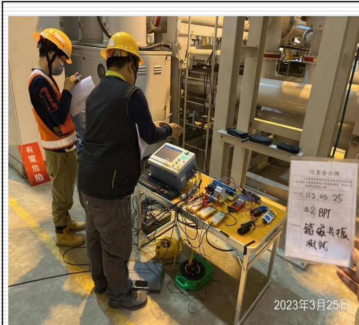
161kV GIS設備鐵磁共振測試驗證
