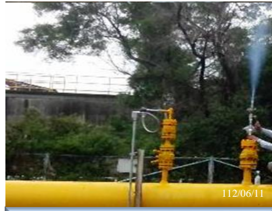
音波測漏系統洩漏測試
