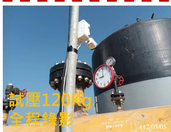
DN900鋼管水壓測試(A)
