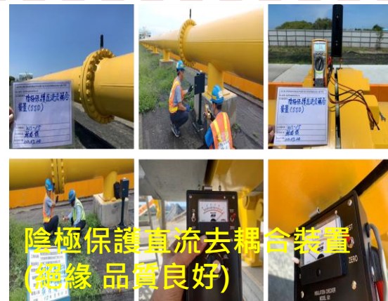
DN900鋼管絕緣隔離測量
