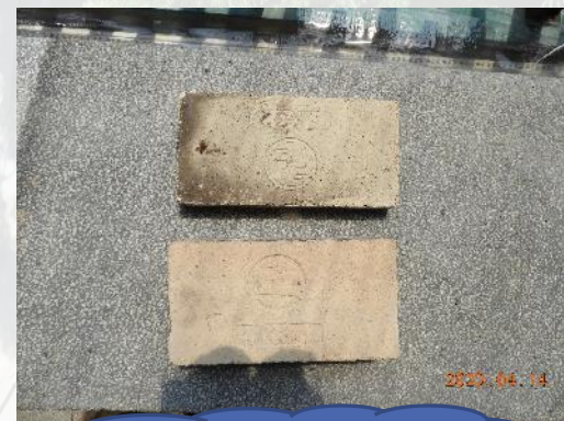
焚化爐內耐火磚
