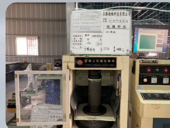
混凝土試體抗壓試驗
