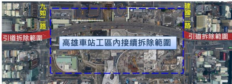
引道段拆除前須先完成相關配套保護措施，(如既有建物保護作業、交通改道動線標誌牌面安裝、施工前鄰房鑑定作業、圍籬設置及防塵網施作..等)，如下圖所示。
